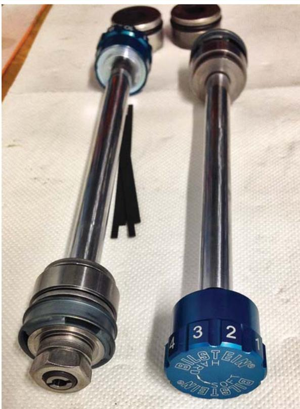
netto miglioramento in termini di handling e di resa in pista. La base di partenza, anche in questo caso, è quella degli ammortizzatori Bilstein PSS10 con molle Eibach, con regolazione separata del freno idraulico in
