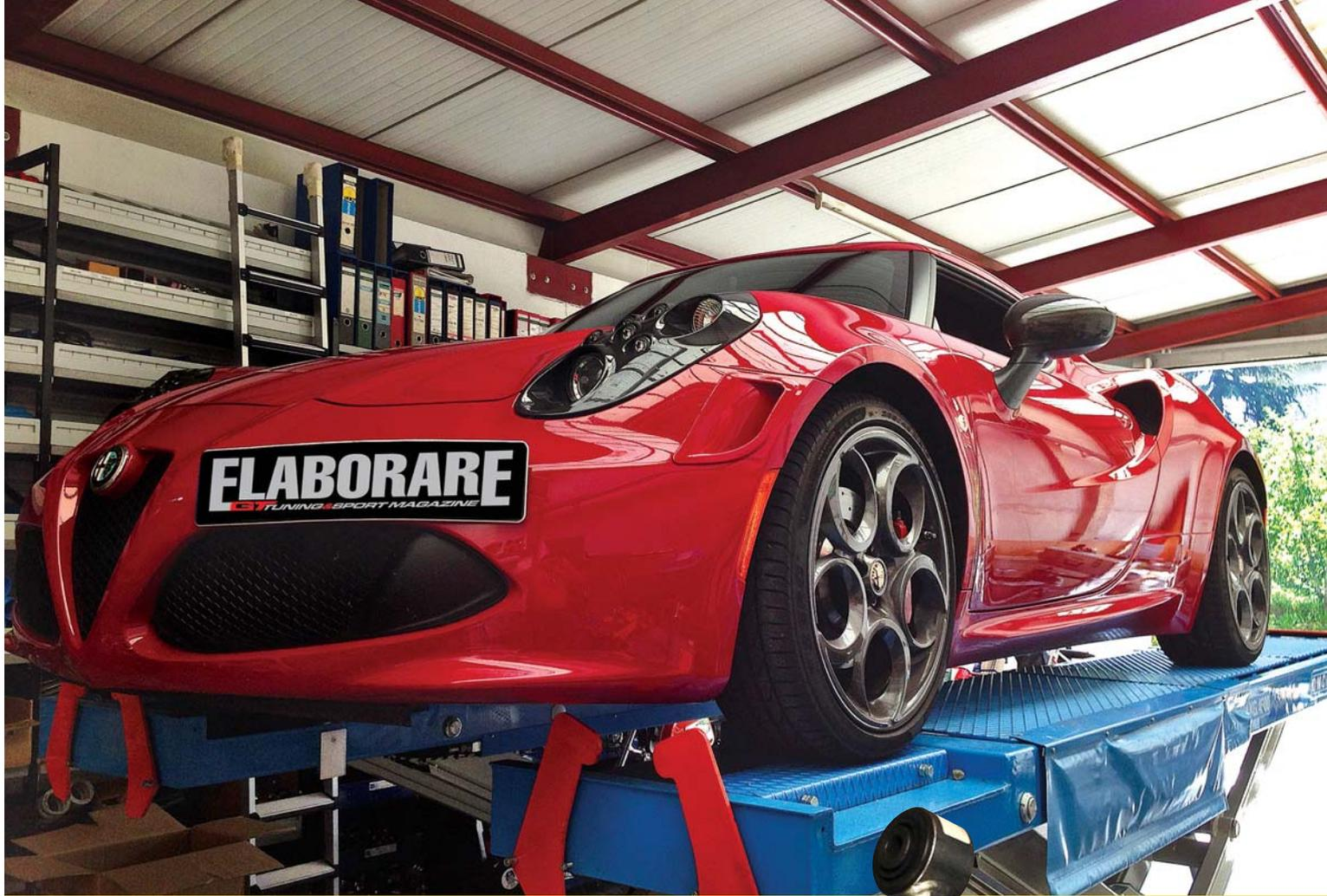
kit sviluppati ex novo, completamente regolabili. La base di partenza è quella della famiglia di ammortizzatori coilover Bilstein PSS10, monotubo a gas regolabili nel freno idraulico in compressione, estensione e nell'altezza tramite ghiera filettate. Entrambe le vetture sono state testate a fondo prima di deliberare il set up ideale a livello di idraulica e carico delle molle, ottenendo in entrambi i casi eccellenti risultati.
