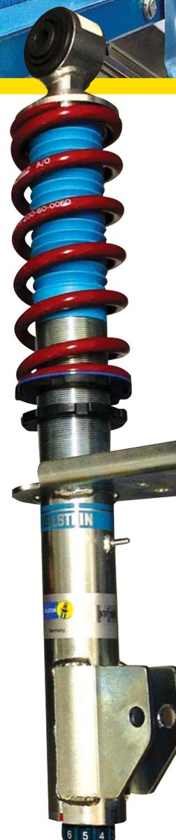
questo assetto era di poter disporre di un kit estremamente versatile, in grado di adattarsi a qualsiasi pista e all'uso stradale. Come accennato, partendo dal set up degli ammortizzatori Bilstein a taratura fissa, i tecnici della NTP hanno approntato due diversi set di ammortizzatori regolabili Bilstein PSS10 abbinati a molle Eibach per il primo test dell'auto, svolto sull'impegnativo circuito di Imola. Nel corso di questa prima
