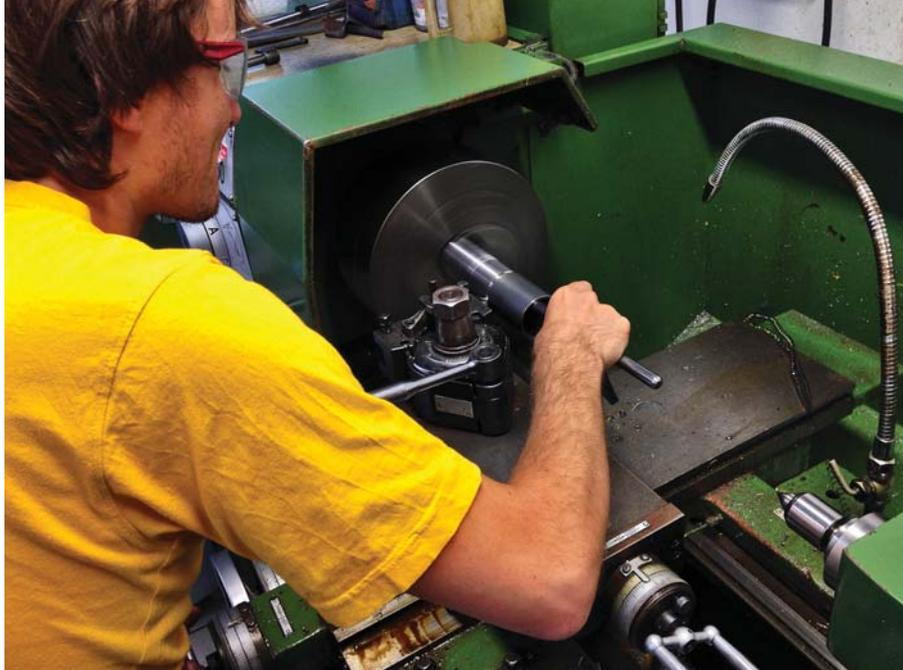
Al tornio avviene la lavorazione del fodero e la filettatura dello stesso. Successivamente, l'artigiano effettua la saldatura delle flange necessarie per il montaggio. Nelle foto, l'ammortizzatore posteriore della 4C.
